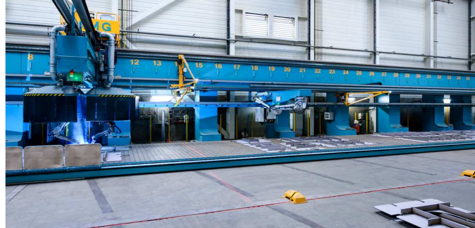
Peene-Werft Wolgast: Schweißroboter im Einsatz – Fertigungsanlage zum automatisierten Schweißen von Bauteilen
