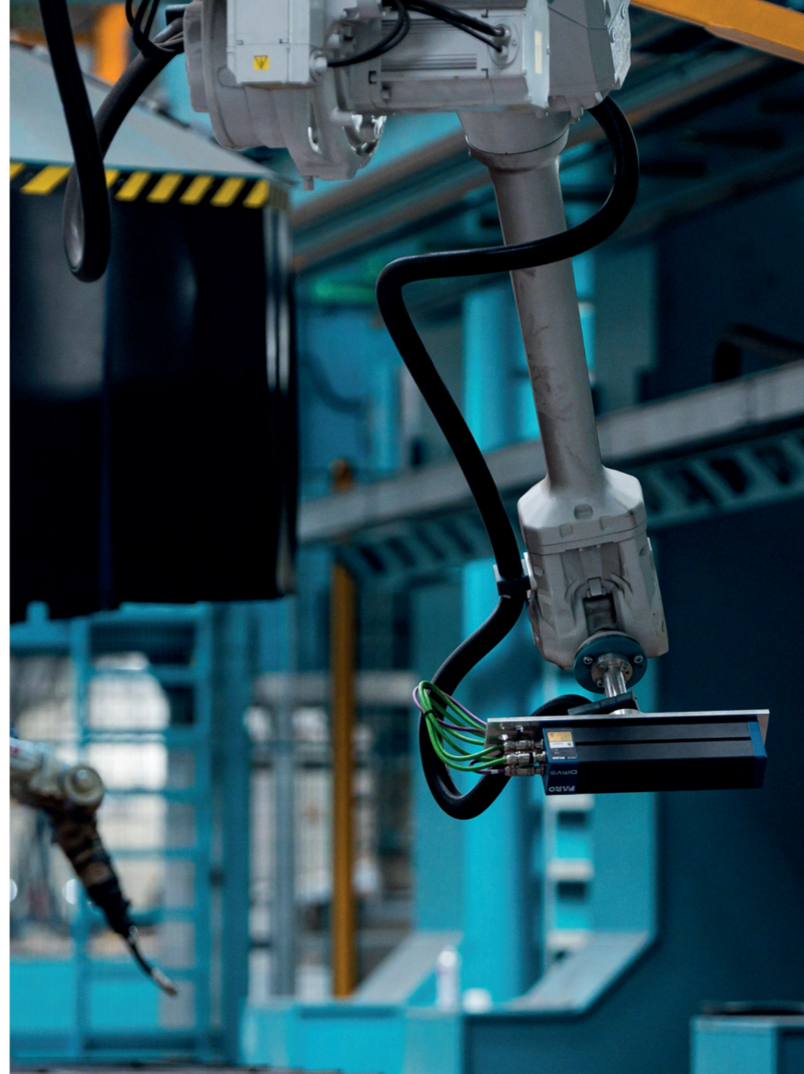
Ein 3D-Sensor erfasst millimetergenau die Abmessungen des zu schweißenden Bauteils
