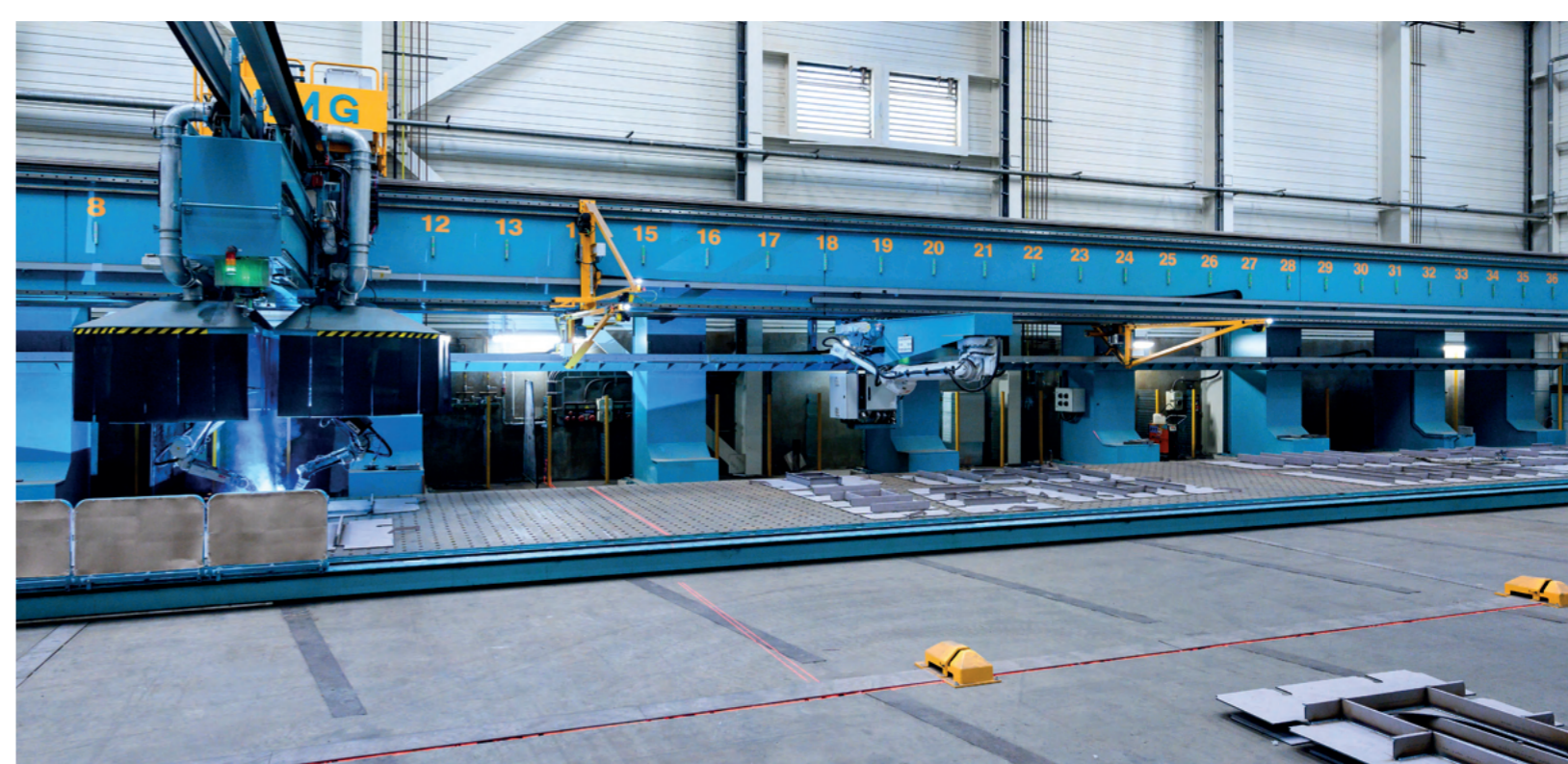
Peene-Werft Wolgast: Schweißroboter im Einsatz – Fertigungsanlage zum automatisierten Schweißen von Bauteilen
