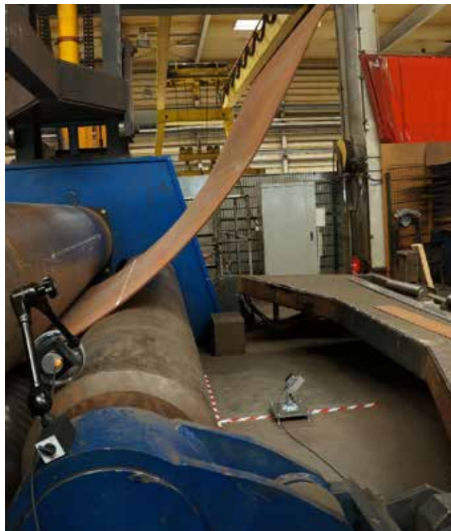
Vermessung der Blechumformung mithilfe der entwickelten Prozessüberwachung.
