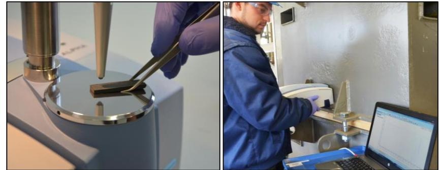
IR-Laboranalyse eines Feststoffes
