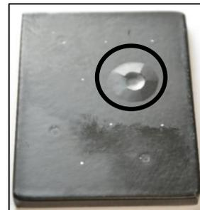
Impact-Test an Beschichtungen und Bauteilen
