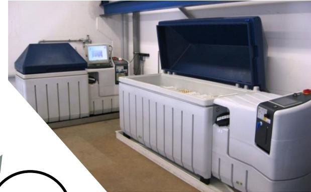
Prüfkammern SC/KWT 450 (links) und SC/KWT 1000 (rechts)
