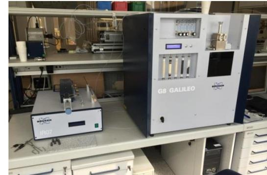
Analysesystem bestehend aus Infrarotofen und Schmelzofen zur Bestimmung des Wasserstoff/Sauerstoff/Stickstoff-Gehaltes in Stahl, Kupfer, Aluminium und Titan
