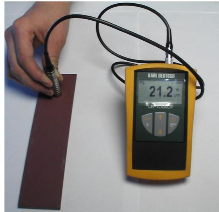
Schichtdickenmessung mit einem Leptoskop 2042 mit Fe-Sonde ( 0-3.000  $\mu\text{m}$ )
