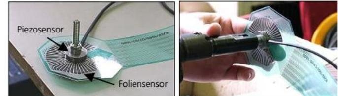
Klemmkraftermittlung in Schließringbolzenverbindungen mit piezoelektrischen Sensoren (Sensorhöhe: 3 mm) und Foliensensoren (Sensorhöhe: 0,1 mm)
