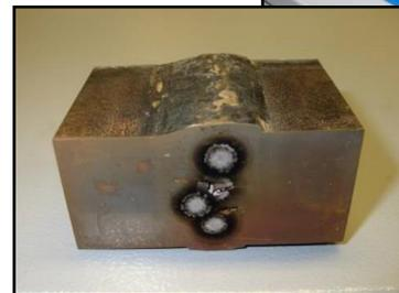
Schweißgutanalyse mit Prüfabdrücken
