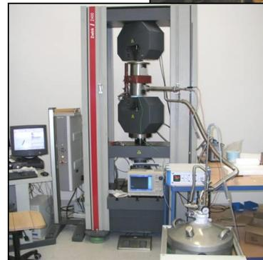
Kaltgasanlage in Prüfmaschine Z400E bei quasistatischen Scherzugversuchen unter kryogenen Bedingungen
