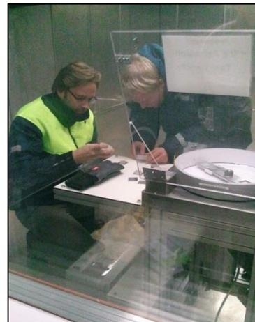
Bestimmung der Eishaftkraft
