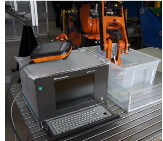
Prüfstand zur automatisierten Ultraschalluntersuchung von Bauteilen bestehend aus einem Roboter, der Ultraschallanlage mit verschiedenen Prüfköpfen und einem Wasserbecken
