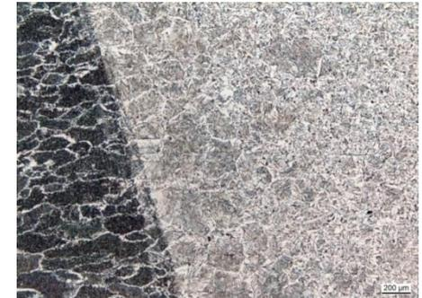
Gefüge einer Schweißnaht
