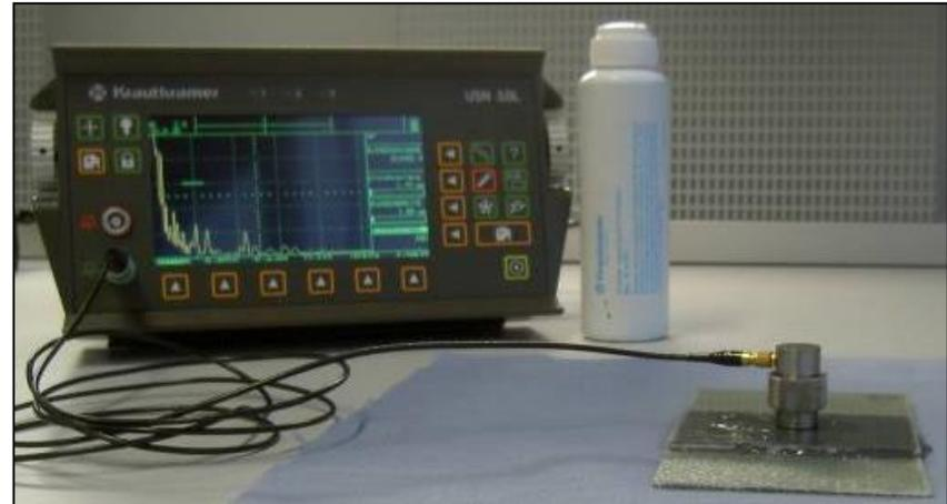
Prüfung einer Klebverbindung mit dem USN 60
