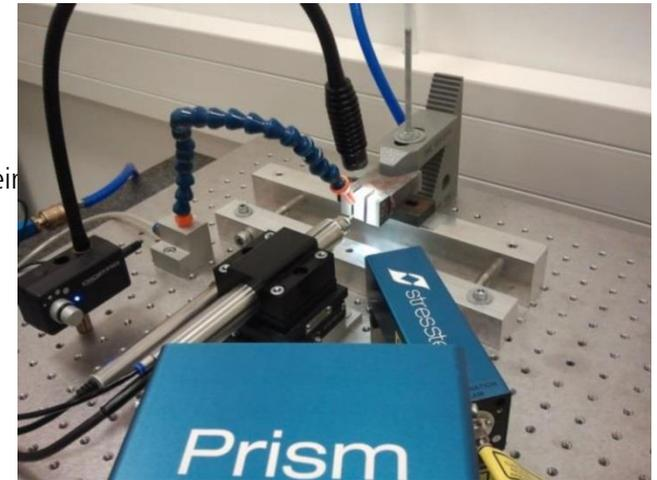
Messaufbau zur Ermittlung des Eigenstresszustands an thermisch gespritzten Proben. Analysesystem bestehend aus Laser-Lichtquelle, Beleuchtungsstand, Kameraeinheit und elektrischer Hochgeschwindigkeitsbohrmaschine
